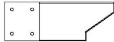
D2 | EXTREMO DE LA VIGUETA-W4L14098 (1) | 1 7/16"x5 1/4"x15" (36x134x381)
