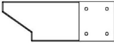
D1 | EXTREMO DE LA VIGUETA-W4L14097 (1) | 1 7/16"x5 1/4"x15" (36x134x381)
